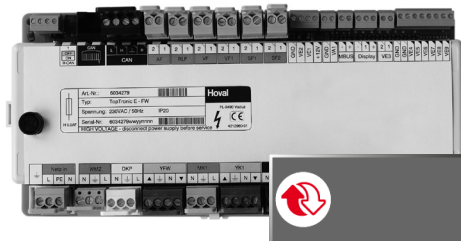
System sterowania TopTronic® E dla centralnego ogrzewania / świeżej wody
