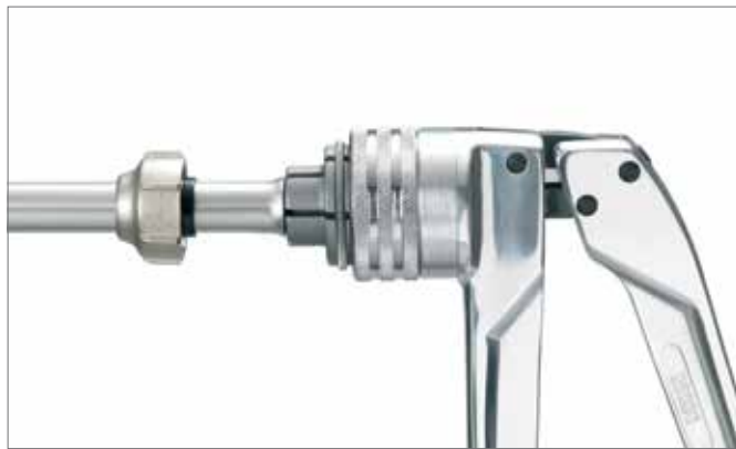
Rys. 14-2 Rozszerzyć koniec rury
