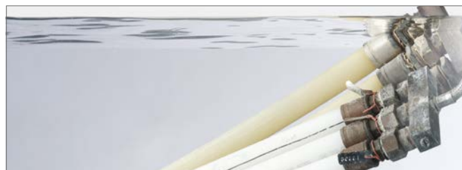
Rys. 3-4 Rury w teście długookresowym (pod ciśnieniem w basenie wodnym)
