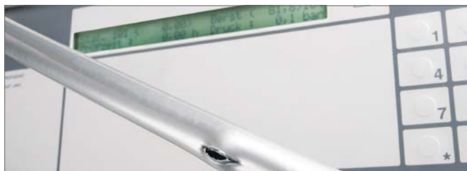
Rys. 3-1 Wynik badania ciśnienia rozrywającego z rurą uniwersalną RAUTITAN flex
