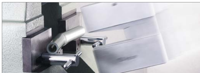
Rys. 3-2 Rura uniwersalna RAUTITAN flex w urządzeniu do badania udarowości
