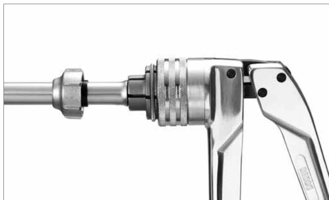
Rys. 5-13 Rozszerzyć koniec rury
