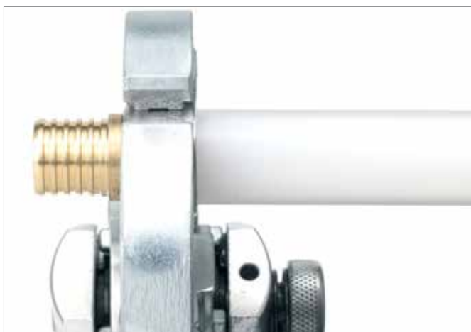
Rys. 12-4 Nałożyć cęgi zaciskowe RAUBASIC na tuleję zaprasowywaną
