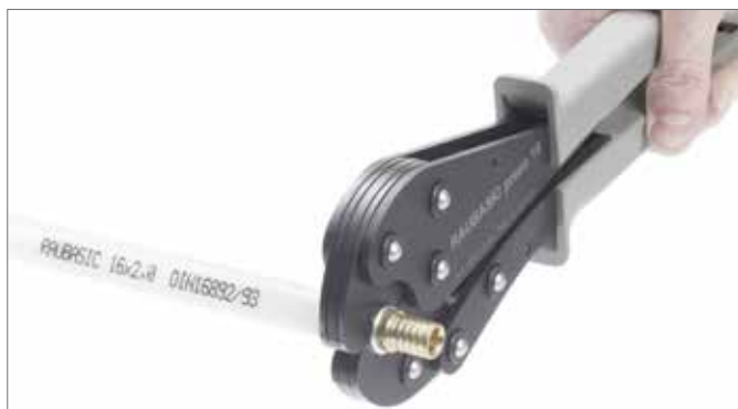
Rys. 12-11 Nałożyć narzędzie RAUTOOL press na tuleję zaprasowywaną
