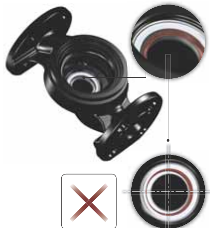
Rys. 12 Nieprawidłowo wyśrodkowane uszczelnienie
