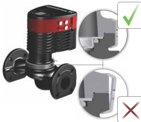
Rys. 9 Montaż głowicy pompy na korpusie pompy
