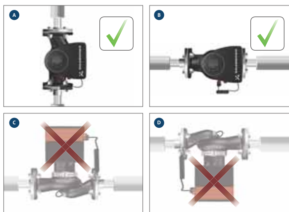
Rys. 4 Pompa zamontowana z wałem w położeniu poziomym
