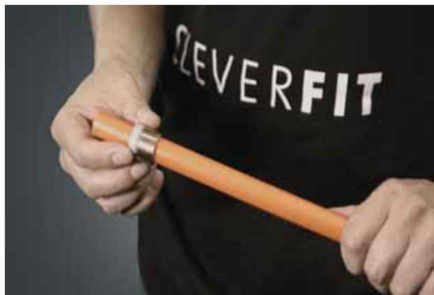
Wsunięcie pierścienia na rurę (część plastikowa skierowana w stronę złączki)
