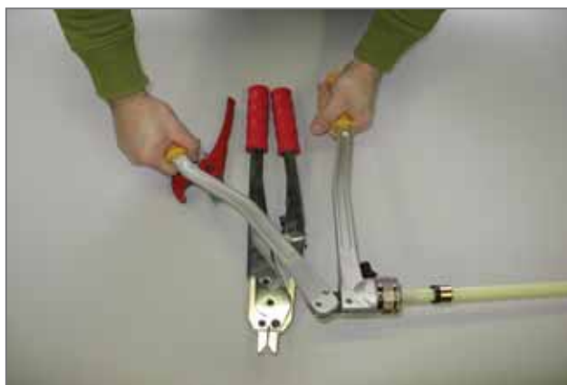
Rozszerzenie rury (3 razy, po każdym rozszerzeniu ekspander należy obrócić)
