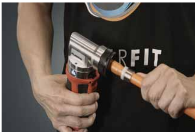
Rozszerzenie rury (2 razy, po 1 rozszerzeniu ekspander należy obrócić)
