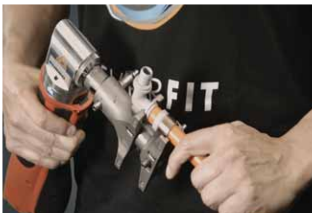
Nasunięcie pierścienia na złączkę
