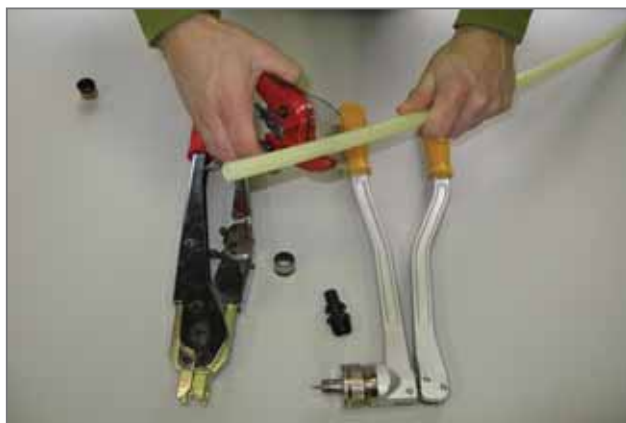
Prawidłowe ucięcie rury
