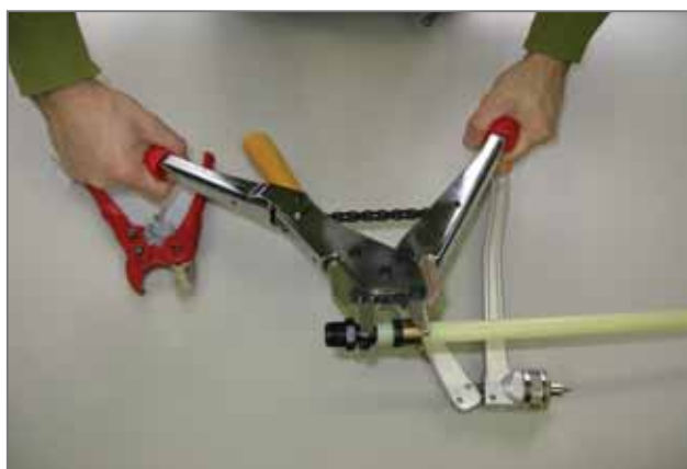
Nasunięcie pierścienia na złączkę
