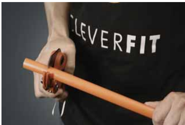
Prawidłowe ucięcie rury
