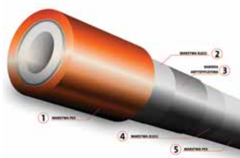
Rysunek 46 Struktura rury PexPenta
